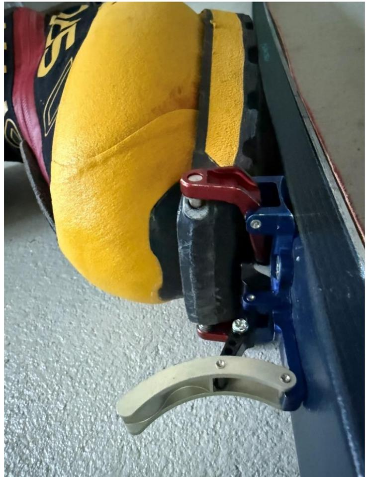
Der Prototyp Selun Race 98 hat die 600km Grönlandüberquerung ohne jeglichen Zwischenfall überstanden: Temperaturen bis  $-40^{\circ}\text{C}$ elsius, rund 300mal Ein- und Aussteigen. Die Abfahrt bei widrigsten Umständen im Kampf mit dem Schlitten, gefolgt von einigen Stürzen.
